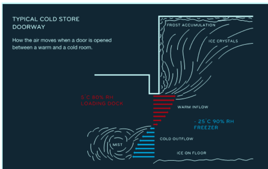
Figur 2 Lufttrycksdriven lufttransport vid dörröppning till fryslager. Figur från (18)
